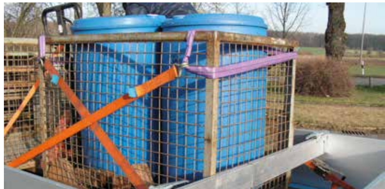
Flüssigkeiten in mobilen Tanks müssen formschlüssig mit dem Fahrzeug verbunden werden. Werden die Tanks in Gitterboxen transportiert, können sie auch durch direktes Verzurren gesichert werden.
